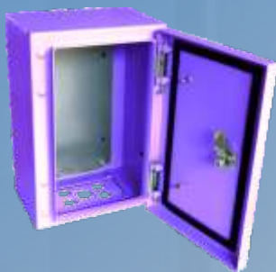
Schaltschrank (BxHxT) 300x400x210 pulverbeschichtet RAL 4005 • Kabeleinführungsöffnungen unten
